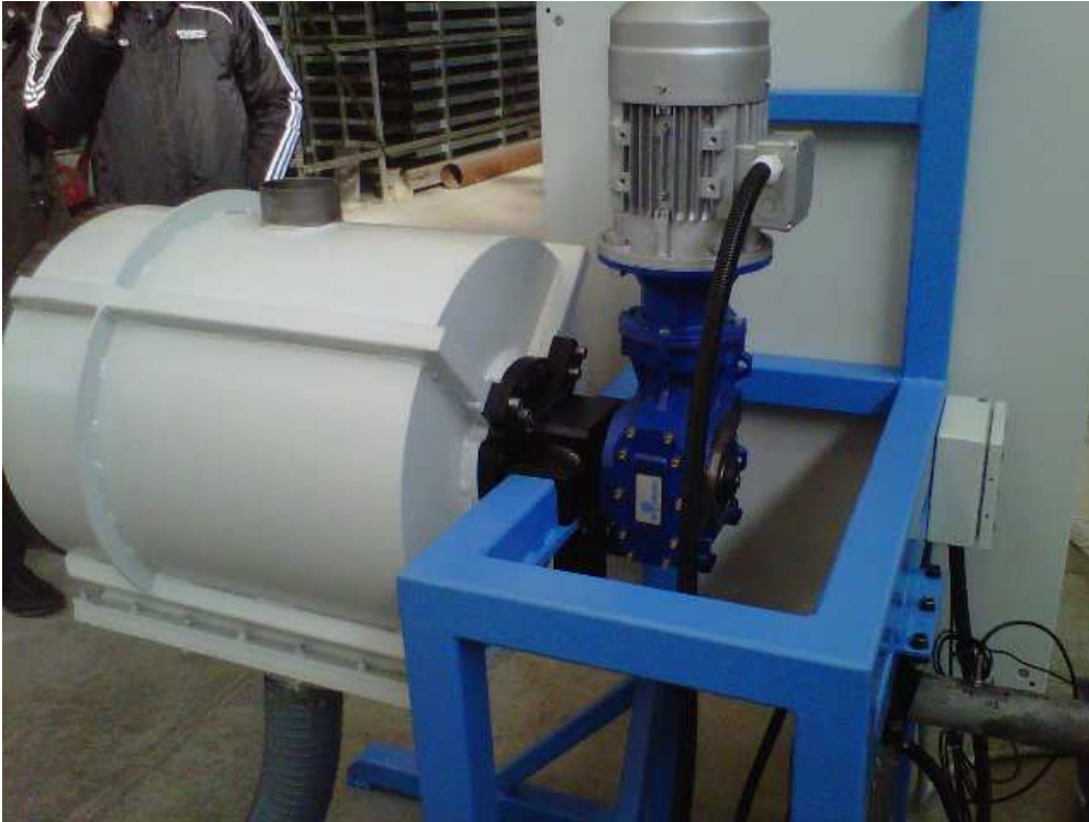
Immagine del dimostratore (schema di impianto impiegato per l'esecuzione del processo di superfinitura a letto fluido abrasivo).
