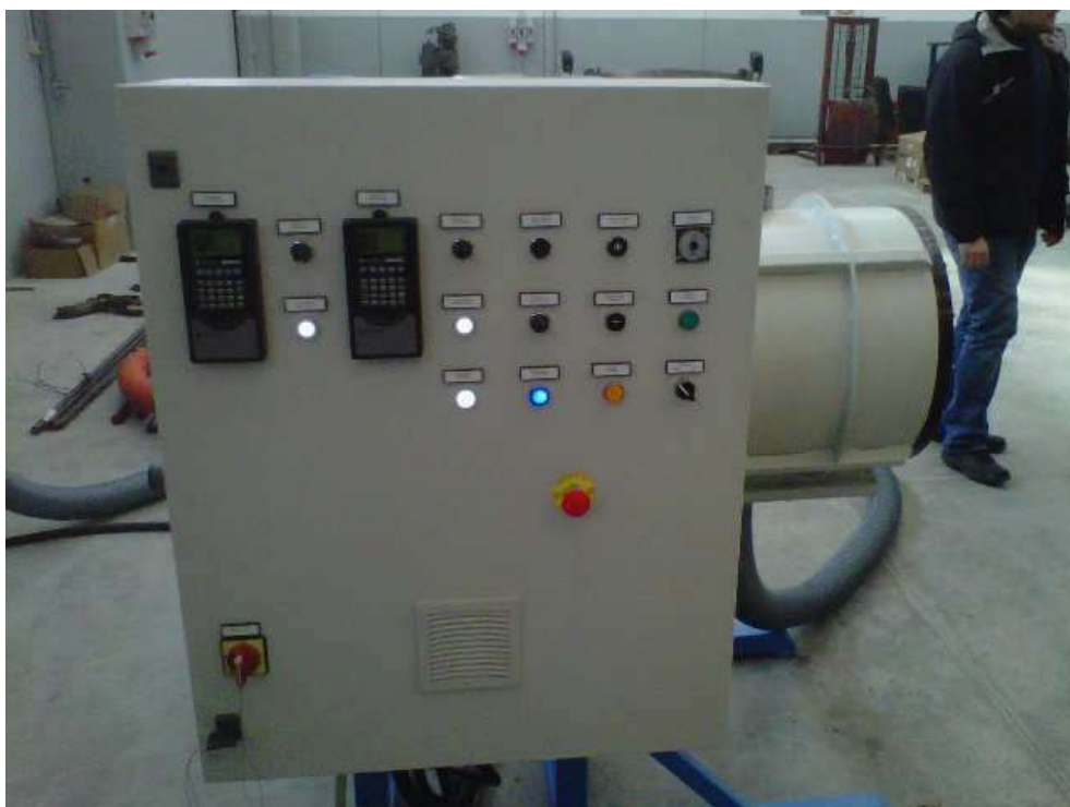
Immagine del dimostratore (schema di impianto impiegato per l'esecuzione del processo di superfinitura a letto fluido abrasivo).
